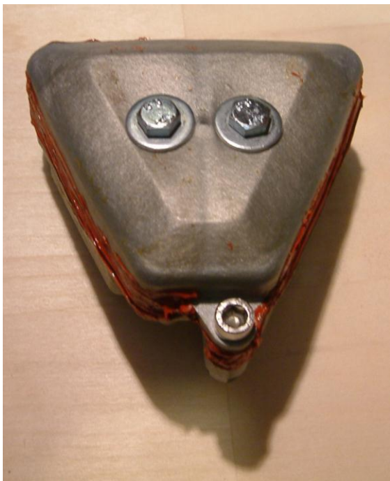
Reparatur einer YICS Box
